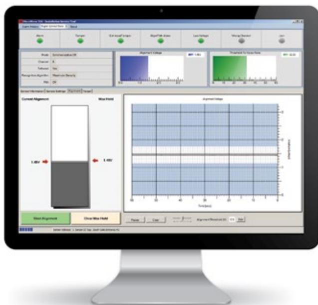
Okno Směrování MW bariéry: směrování dokončeno
